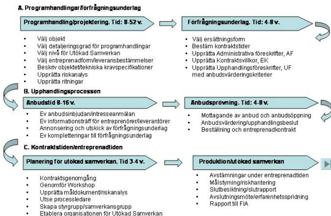
Figur 4. Förslag till handlingsplan för entreprenader med Utökad Samverkan
